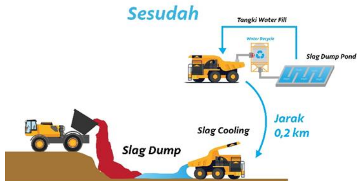
Gambar 16. Proses Setelah Implementasi Program Clear Slag Cooling
