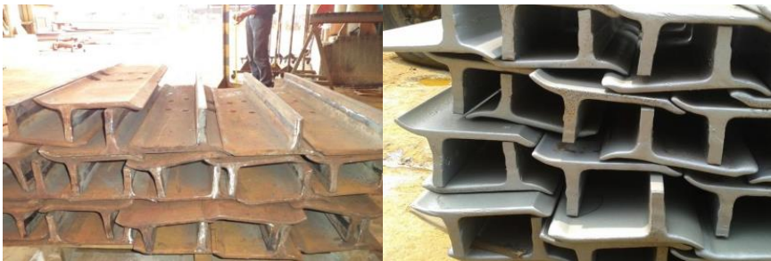
Gambar 19. Kondisi Track Shoe saat fabrikasi regrouser
