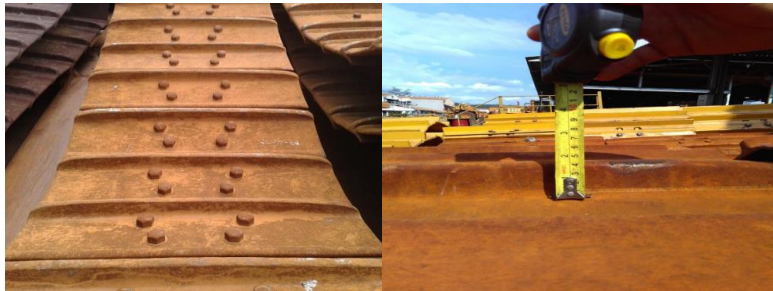
Gambar 18. Kondisi Track Shoe sebelum implementasi
