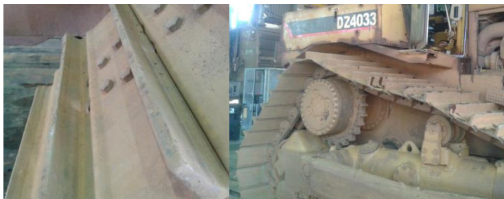
Gambar 21. Kondisi Track Shoe setelah 1,5 bulan Implementasi
