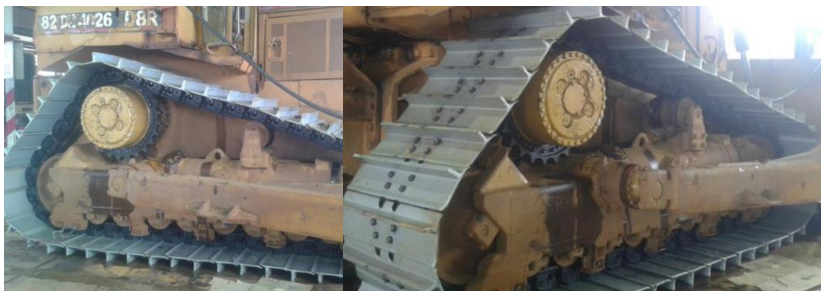
Gambar 20. Kondisi Track Shoe saat setelah terpasang
